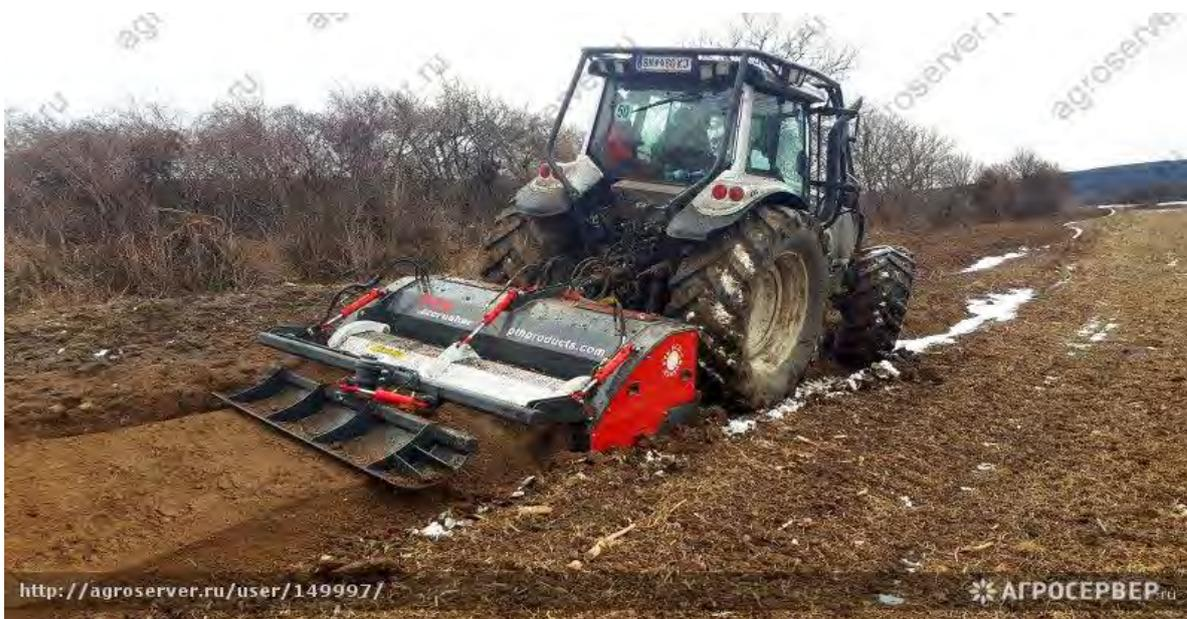
**Рисунок 4 - Универсальная фреза РТН Eco Crusher**
