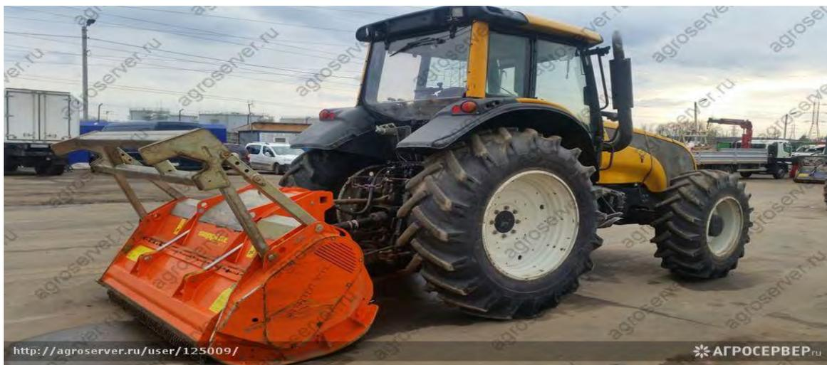
**Рисунок 3 – Мульчер- роторатор Midisoil dt Seppi**
