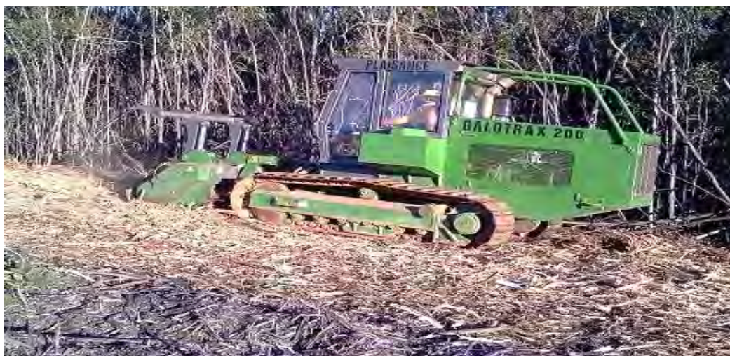
Рисунок 2 – Самоходный гусеничный мульчер за работой
