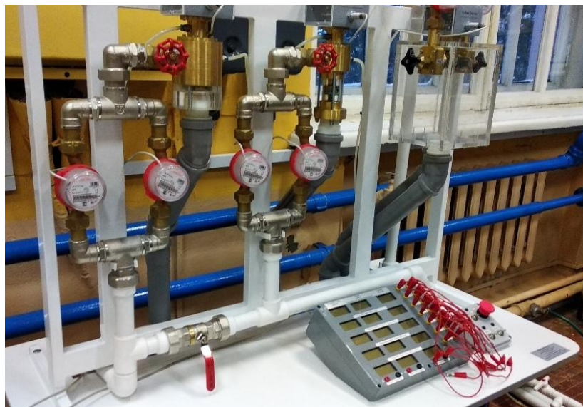
Рис.1. Лабораторный комплекс ГСТГ -010-10ЛР «Гидроэнергетика – система турбина генератор»
