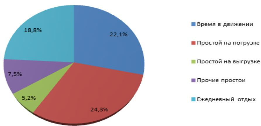
Рис. 2. Структура общего времени ездки транспортного средства
