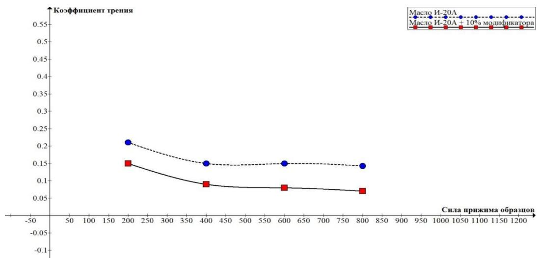
**Рис.2. Зависимость Коэффициента трения от силы прижима образцов**
