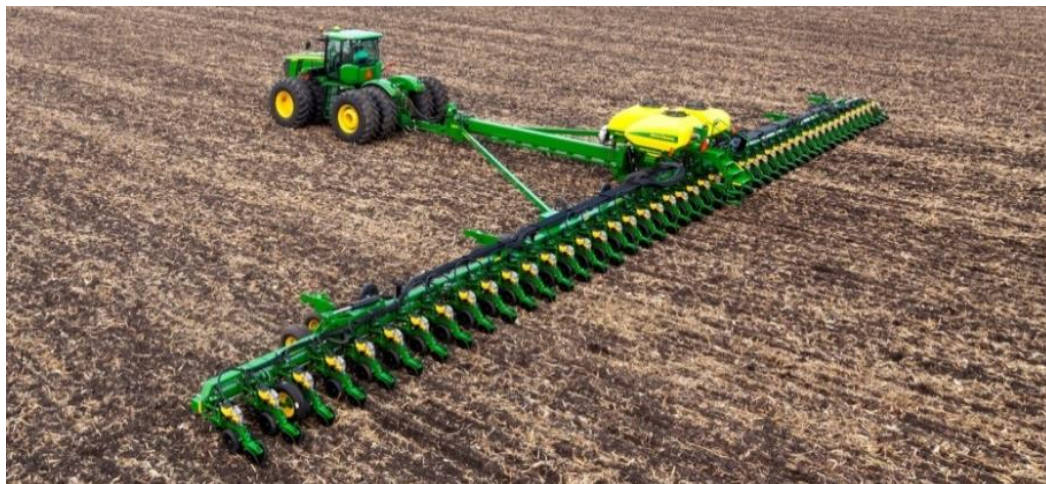
Рис.1. Сеялка точного высева John Deere Db120 48 row 30
