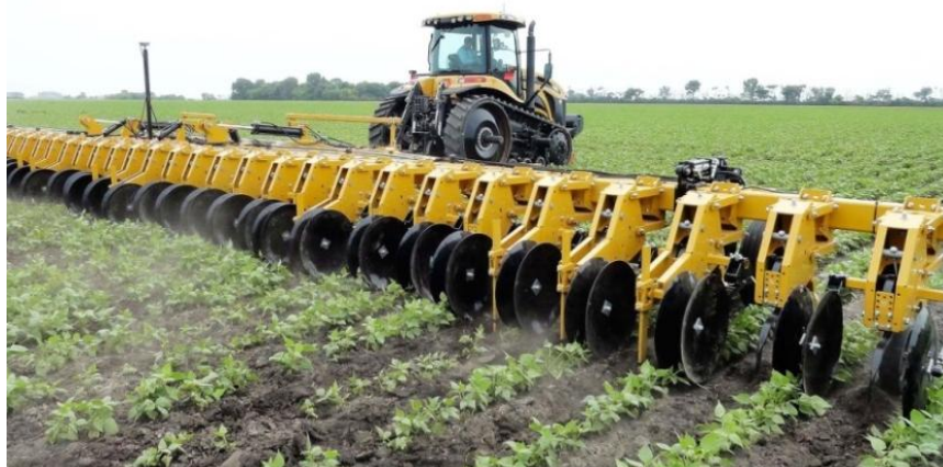
Рис. 2. Гусеничный трактор Challenger MT 755E с 36 рядным междурядным культиватором
