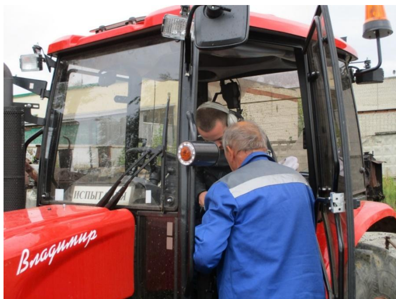
Рис. 1. Настройка шумомера перед замером шумовых показателей
