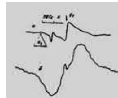
Рис. 3. Спектры ЭПР замороженных растворов хлора в фторбензоле (а) и гексафторбензоле (б) после фотолиза в ближнем УФ. (а) дополнительно показана сверхтонкая структура спектра, связанная с расщеплением на атоме фтора [7,8].
