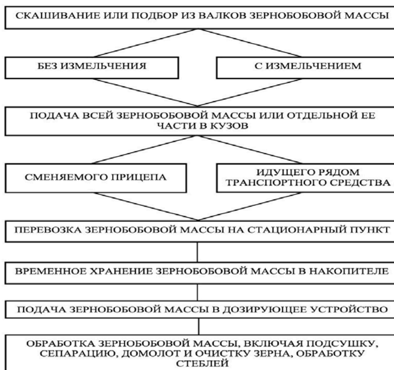
Рис. 1. Обобщенная технологическая схема многофазной уборки зернобобовых культур
