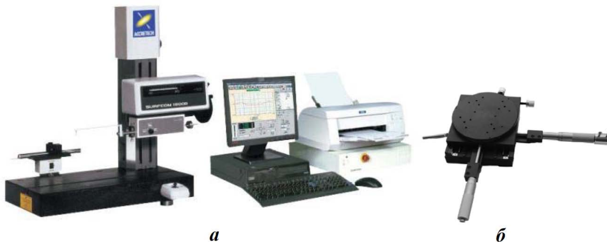
Рис. 1. Профилограф Surfcom 1800D: а – общий вид; б – предметный столик
