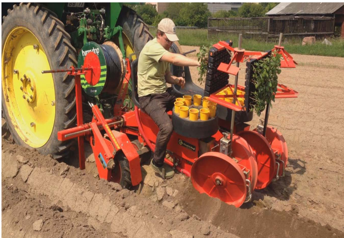
Рис. 2. Укладчик капельной ленты на базе рассадопосадочной машины Cecchi & Magli
