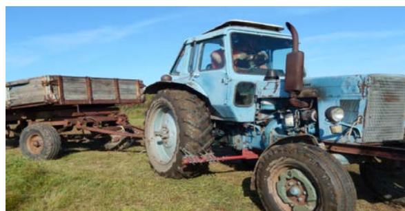
Рис. 2. Тракторно-транспортный агрегат с торсионно-тросовым очистителем протектора двигателя
