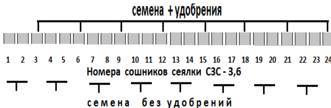
Рис. 1. Схема регуляции сошников сеялки СЗС–3,6 для частичного разделения потоков семян при посеве
