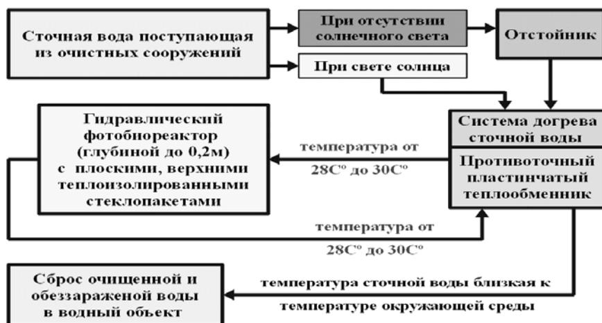
**Рис. 1. Базовый вариант процесса биологической переработки и обеззараживания сточной воды с использованием штаммов *Chlorella vulgaris* (С-111 и BIN) в гидравлическом фотобиореакторе.**
