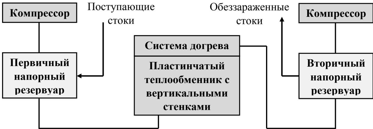
**Рис. 1. Схема процесса прогрева и обеззараживания стоков**
