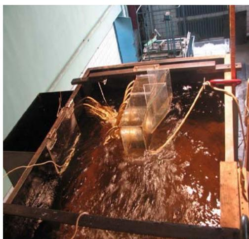
**Рис. 2. Модельная установка сифонного водосброса, заполненная водой**
