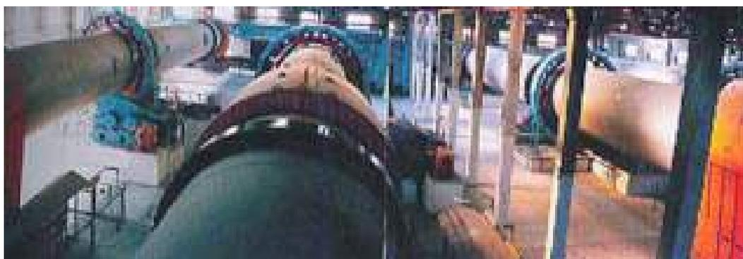
**Рис. 2. Биотермический барабан**
