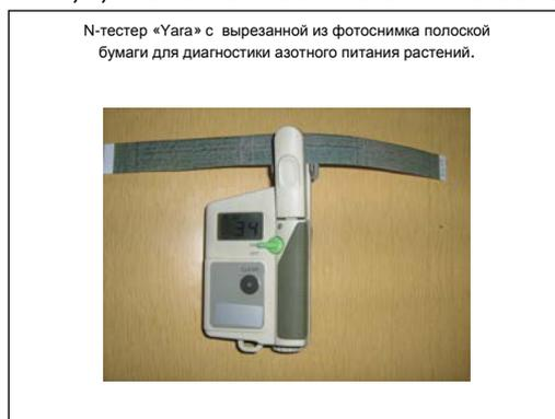
**Рис. 2. Определение обеспеченности посева озимой пшеницы азотным питанием с использованием дистанционного снимка на бумажной основе с помощью портативного фотометра «Yaqa»**
