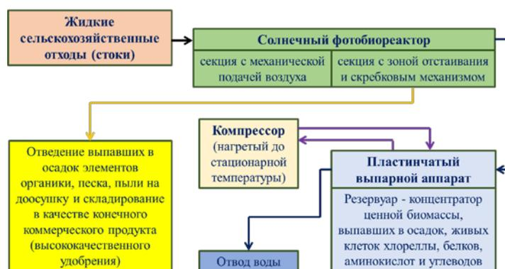
**Рис. 1. Блок-схема процесса биологической переработки органических сельскохозяйственных отходов и стоков в фотобиореакторе**
