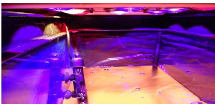
**Рис. 2. Фотобиореактор с установленной, в верхней части, фитолампой и внешним светоизолирующим покрытием**
