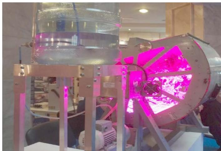
Рис. 1. Фотобиореактор с искусственным режимом освещения
