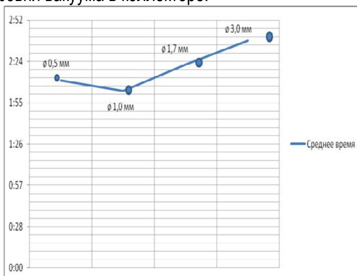
Рис. 2 График зависимости продолжительности доения при различных диаметрах отверстия коллектора доильного аппарата
