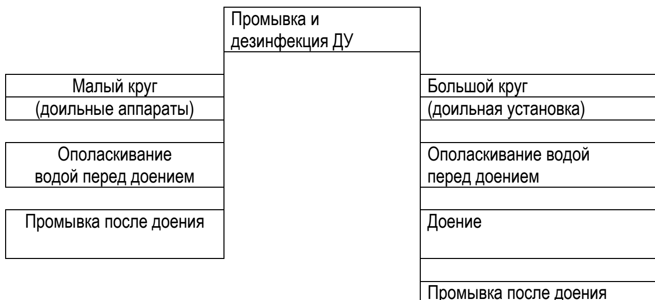
Рис. 1. Структурная схема промывки и дезинфекции доильной установки
