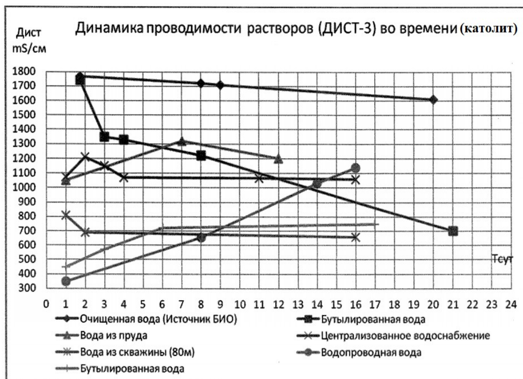
Рисунок 71. – Определение значений проводимости активированных водных растворов в динамике времени
