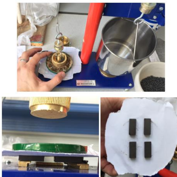
Рисунок 2 - Определение липкости почвы на приборе В.В. Охотина ПЛГ-Ф. 1-общий вид с магнитной установкой. 2-вид сбоку. 3-расстановка магнитов
