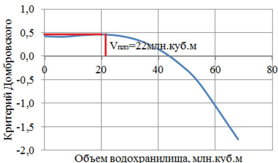
Рис. VII.2 Пример зависимости суммарного критерия оптимизации ( $f$ ) от объема воды в водохранилище ( $V$ ) для неравнозначных критериев
