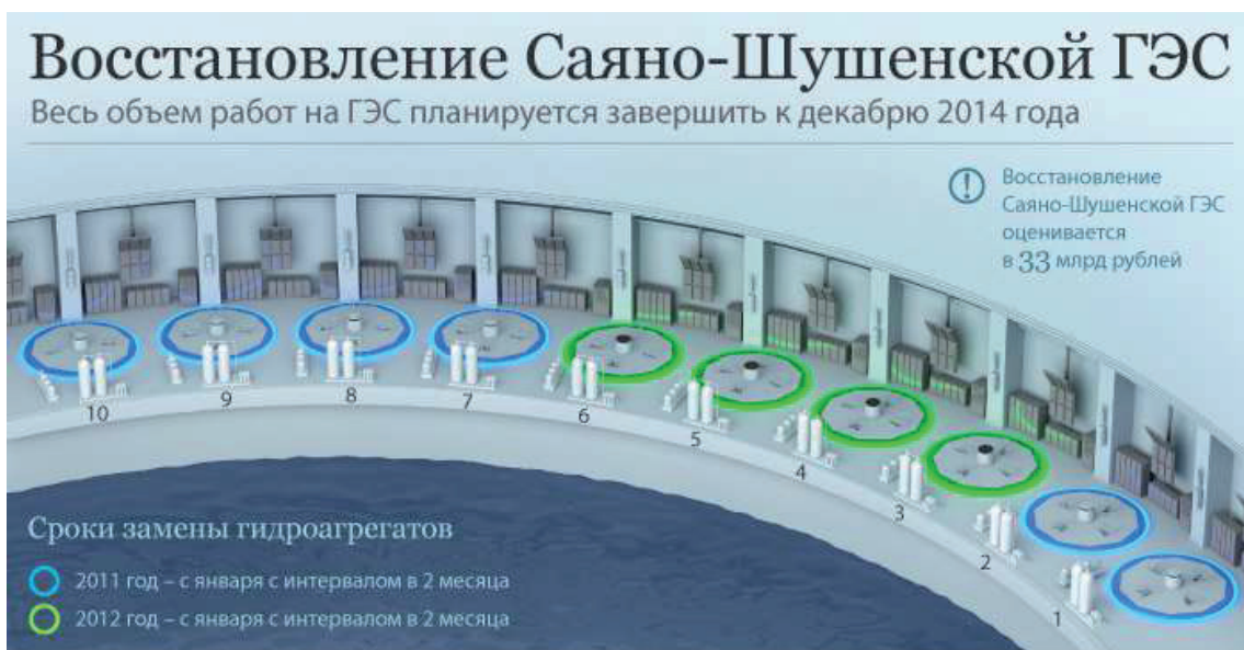
Рис. 4.13. Саяно-Шушенская ГЭС (СШ ГЭС). Мощность – 6400 МВт, 10 агрегатов. Повреждена во время аварии 17 августа 2009 г.
