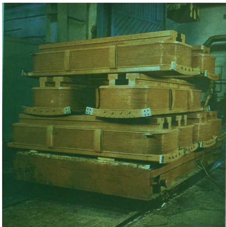
Рис. 4.6. Полюсы мощного синхронного гидрогенератора:
