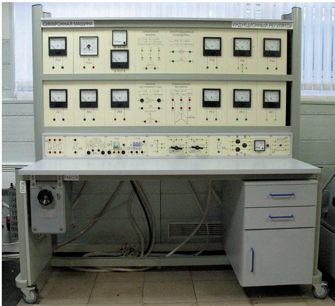
Рис. В1. Общий вид базиса стенда “Синхронная машина”: под столешницей, в верхнем левом углу, расположен пусковой реостат
