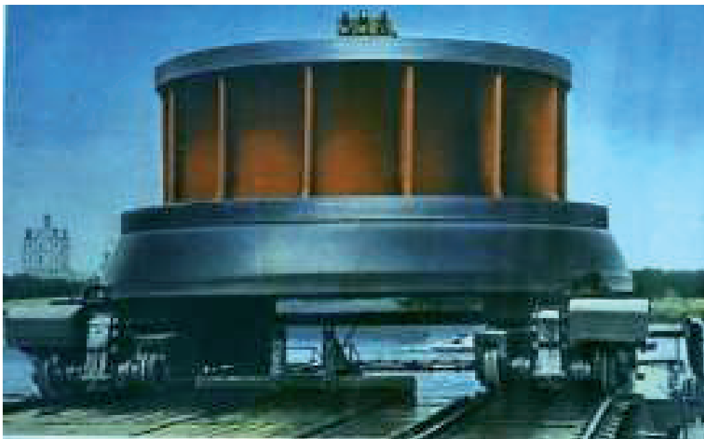
Рис. 4.8. Турбина Красноярской ГЭС. Мощность турбины – 508 МВт. Диаметр колеса турбины – 7,5 м
