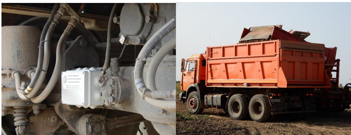
Рисунок 2 – Установка модулей снятия данных движения транспортных средств
