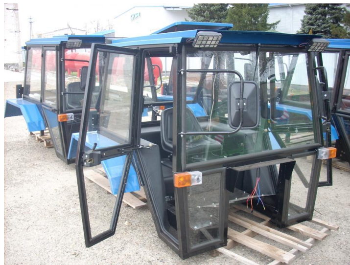
Рисунок 2 – Кабина трактора в разобранном виде с люком для притока воздуха
