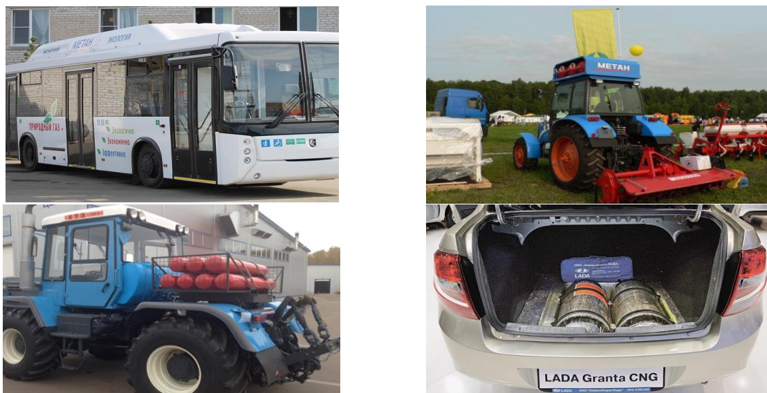
Рисунок 1 – Примеры размещения запаса КПГ в автотракторной технике
