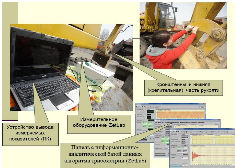
Рисунок 2 – Пример исследований ресурсного потенциала элементов рабочего органа технологической машины путем тензометрирования измерительной системой ZetLab
