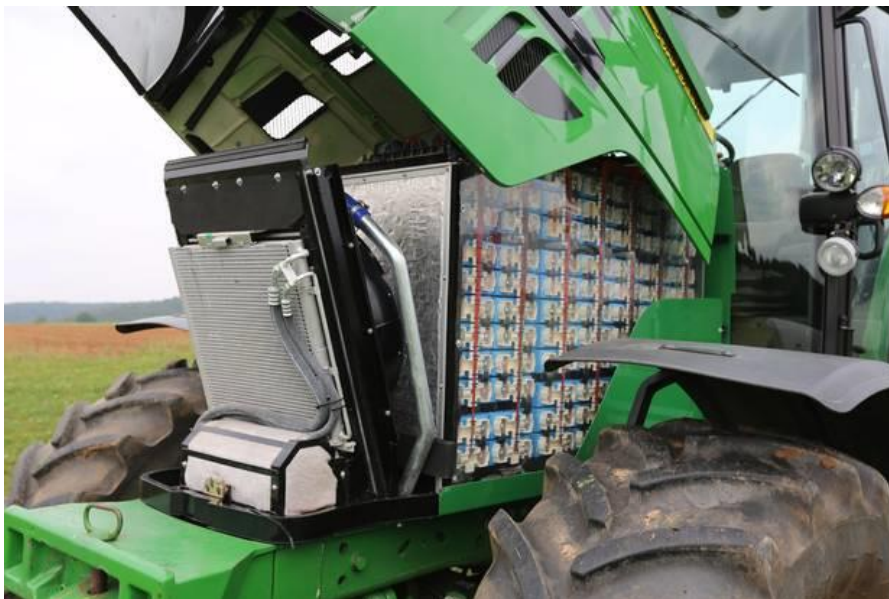
Рисунок 2 – Литий-ионные батареи электрического трактора John Deere Sesam
