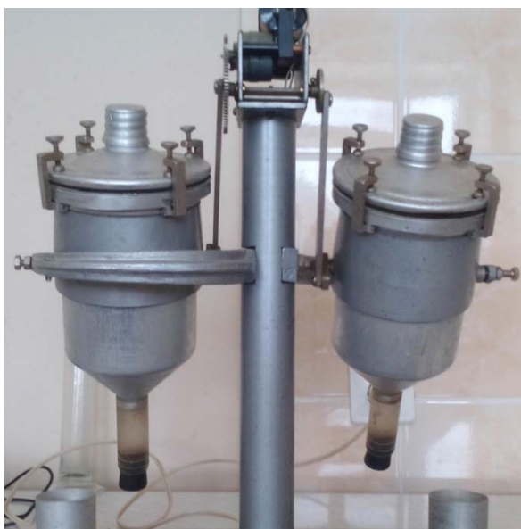
Рис.1 Прибор И.М. Бакшеева для определения водопрочности структуры почвы
