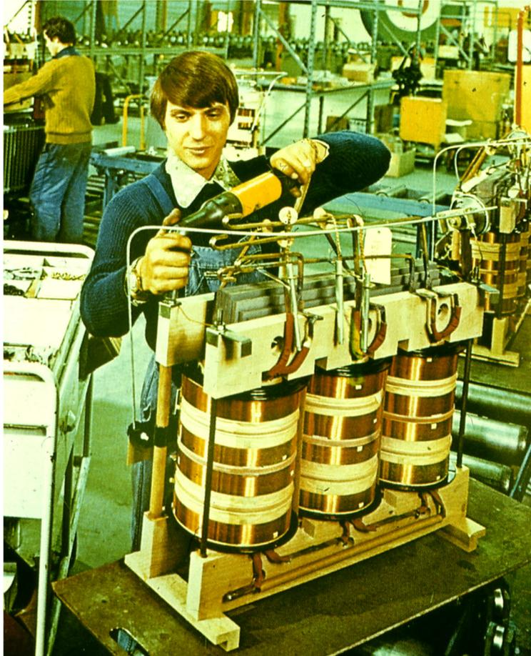
**Рис. 10.18. Распайка выводов обмоток трансформатора**
