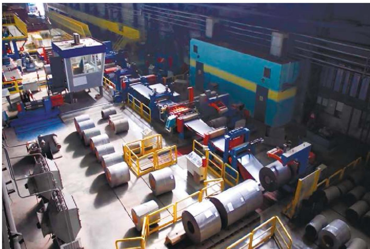
**Рис. В.54. Рулоны электротехнической стали в цехе НЛМК**
