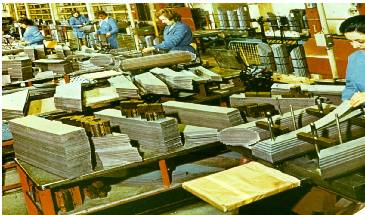
**Рис. 10.13. Шихтовка «в переплет» стержневого магнитопровода трансформатора
