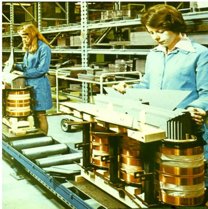
**Рис. 10.17. Зашихтовка верхнего яра магнитопровода трансформатора (косые стыки)**
