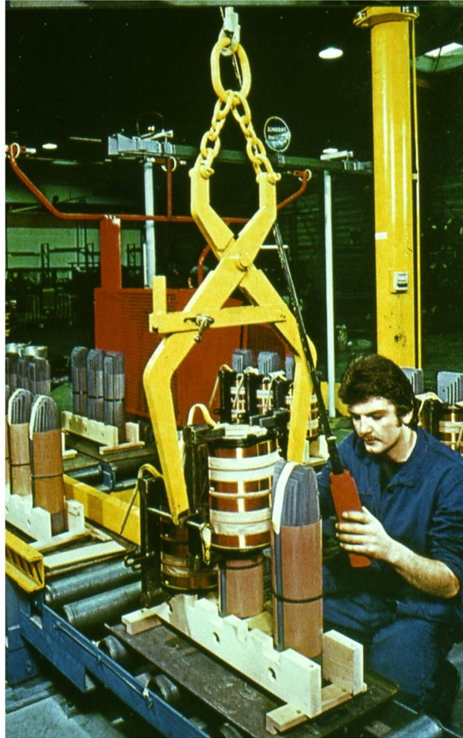
**Рис. 10.16. Насадка обмотки на стержень магнитопровода трансформатора**
