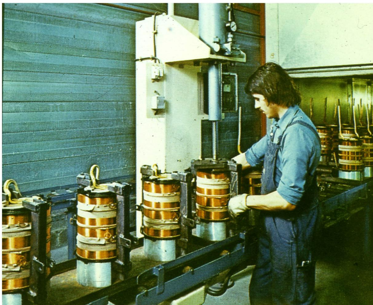
**Рис. 10.15. Осевая опрессовка и сушка обмоток НН и ВН трансформатора**
