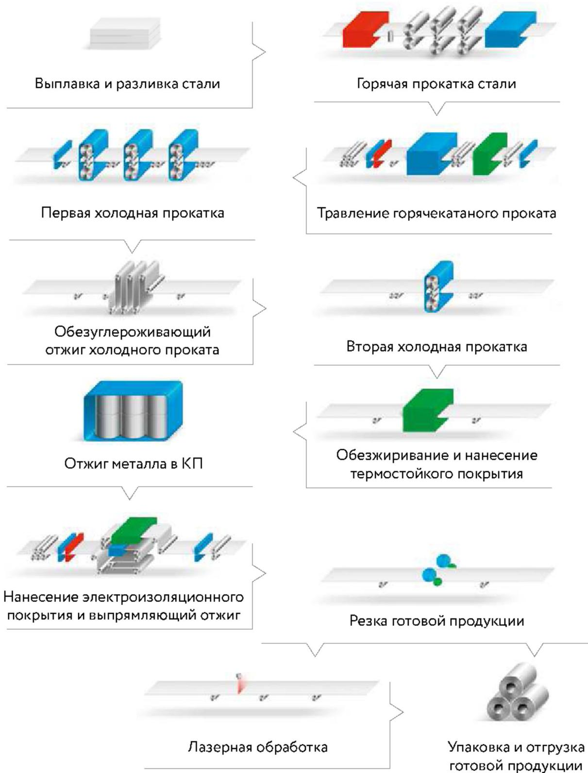
**Рис. В.55. Схема производства электротехнической стали на НЛМК**
