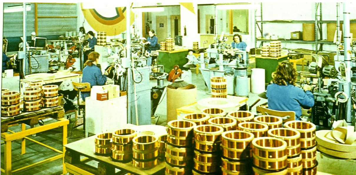
**Рис. 10.14. Участок изготовления обмоток трансформатора**
