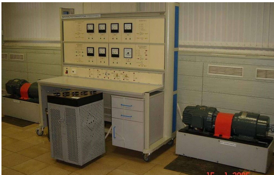
Рис. 7.14. Общий вид стенда “Двигатель постоянного тока” с исследуемыми агрегатами: слева расположен агрегат с ДПТ параллельного возбуждения (Работа № 2); справа – агрегат с ДПТ последовательного возбуждения (Работа № 3)
