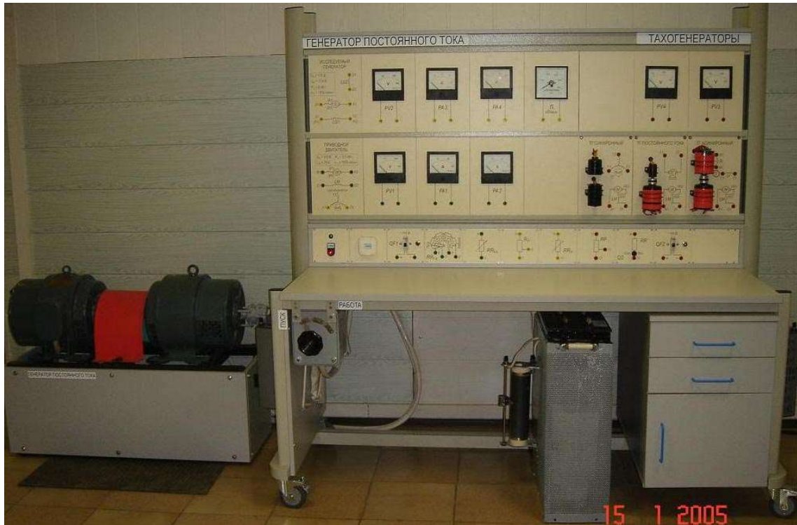
Рис. В2. Стенд “Генератор постоянного тока” с исследуемым агрегатом: слева от стенда расположены генератор и двигатель постоянного тока
