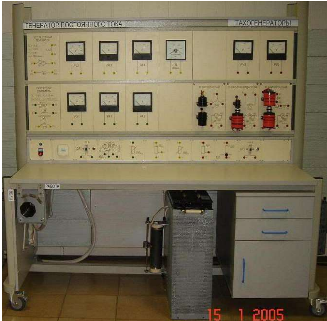
Рис. В1. Общий вид базиса стенда “Генератор постоянного тока”: под столешницей, в верхнем левом углу, расположен пусковой реостат
