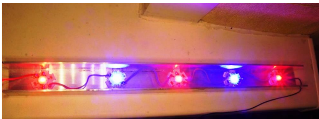
Рисунок – Сборная панель со светоизлучающими диодами синего и красного цвета
