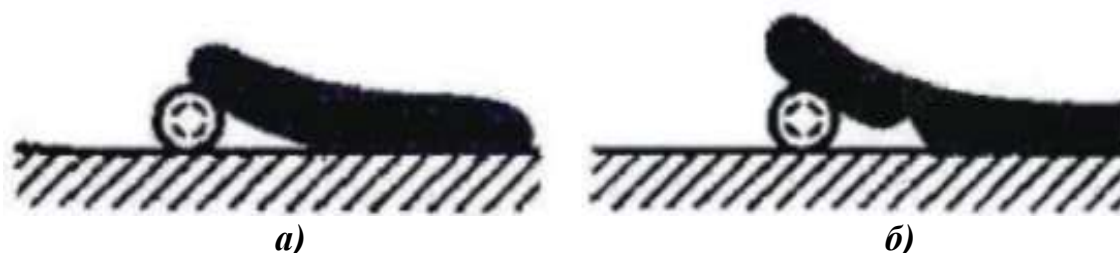
Рисунок 1. Схема отделения загрязнения пульсирующими кавитационными пузырьками: а – начальный момент; б – момент разрыва и отделения
