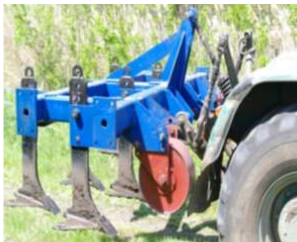
Рисунок 3. «Универсал КубГАУ» (Плуг со складывающимися лапами)
