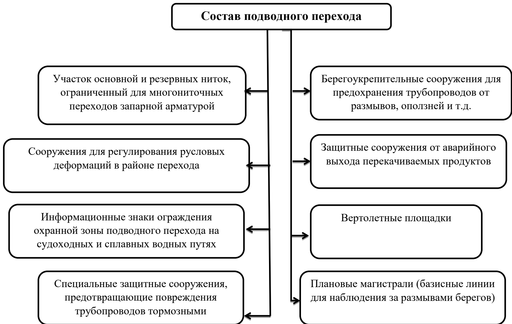
Рисунок 6.1 – Основные конструктивные элементы подводного перехода
