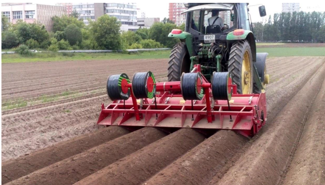
Рисунок 8.3. – Укладчик капельной ленты на базе гребнеобразователя Grimme75/4
