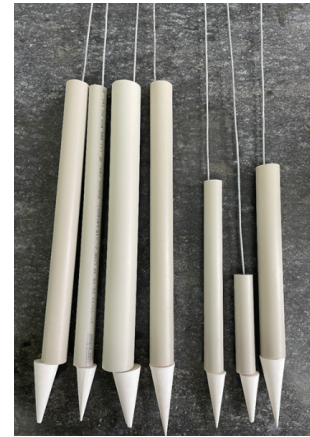
Рис. 3. Модели комбинированных анкеров с коническим наконечником Fig. 3. Models of combined anchors with a conical tip
