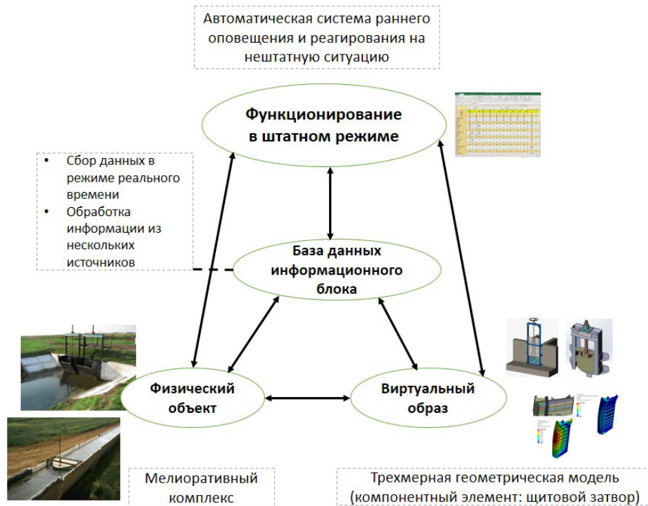
Рис. 3. Типовая модель формирования цифрового двойника мелиоративного комплекса на примере контроля функционирования щитового затвора
