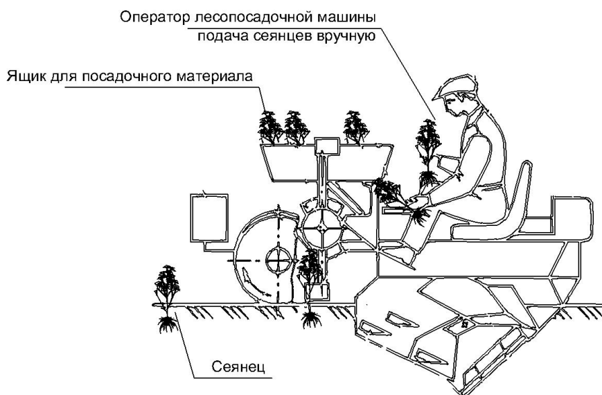
Рис. 1. Схема посадки лесных культур лесопосадочной машиной Fig. 1. The scheme of planting forest crops by a planting machine
