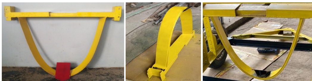
Рис. 2. Рабочий орган с параболическими стойками опытного образца мелиоративного рыхлителя Fig. 2. Working body with parabolic racks of the experimental reclamation ripper
