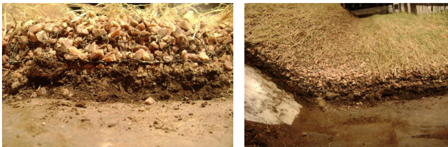
Рис. 9. Состояние покрытия Энкамат 7225, заполненного каменным материалом с пророщенной травой сорта Райграс и растительным грунтом по окончании первой серии экспериментов
