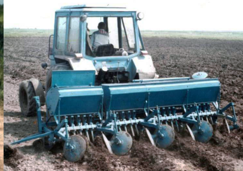
Рис. 6. Гребнеобразующие механизмы. Культиватор гребневой КГ-3,6 (слева) и Сеялка гребневая СГ-3,6 в агрегате с трактором МТЗ-82 (справа)
