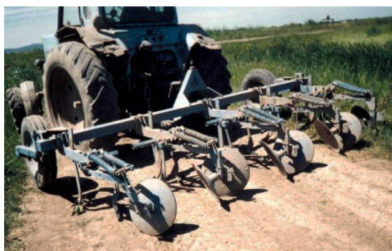
Рис. 6. Гребнеобразующие механизмы. Культиватор гребневой КГ-3,6 (слева) и Сеялка гребневая СГ-3,6 в агрегате с трактором МТЗ-82 (справа)
