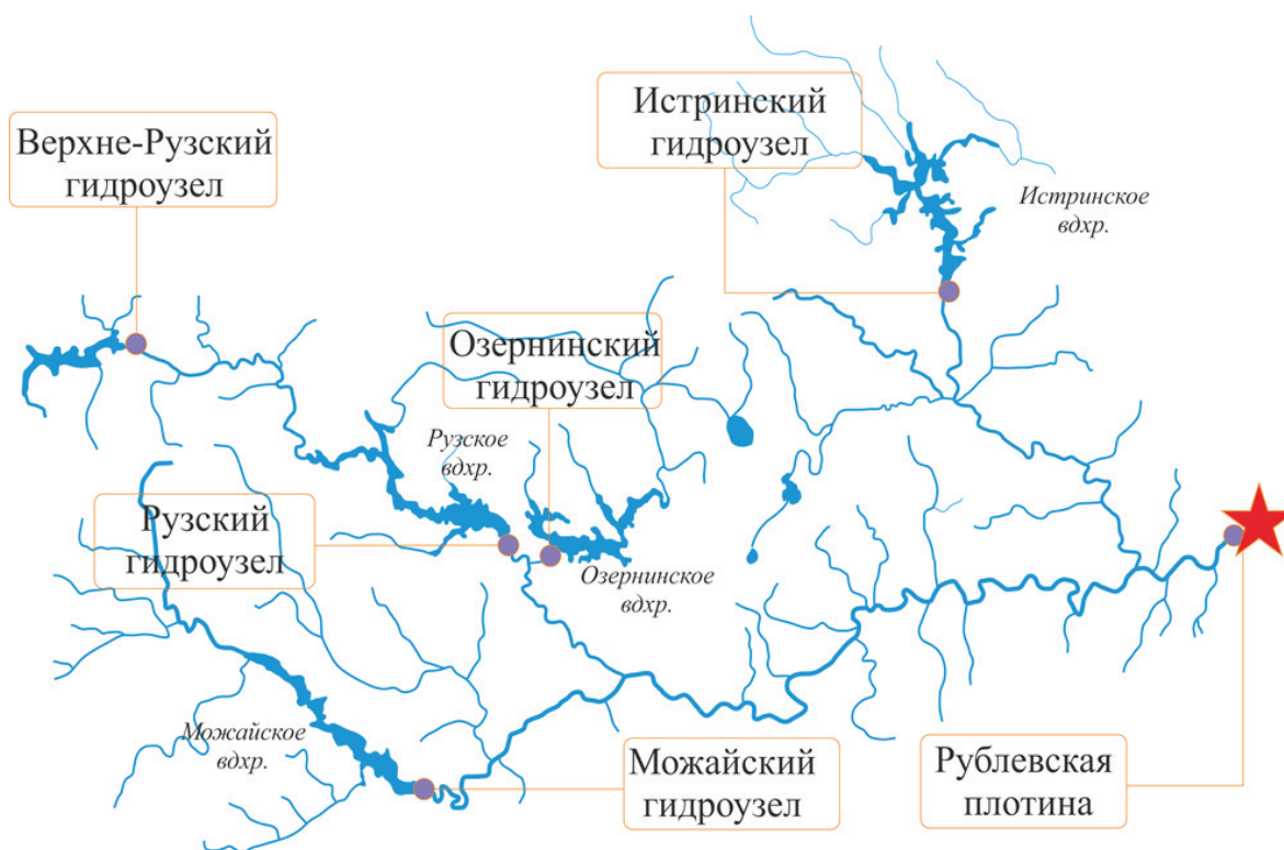
Рис. 1. Схема Москворецкой водной системы
