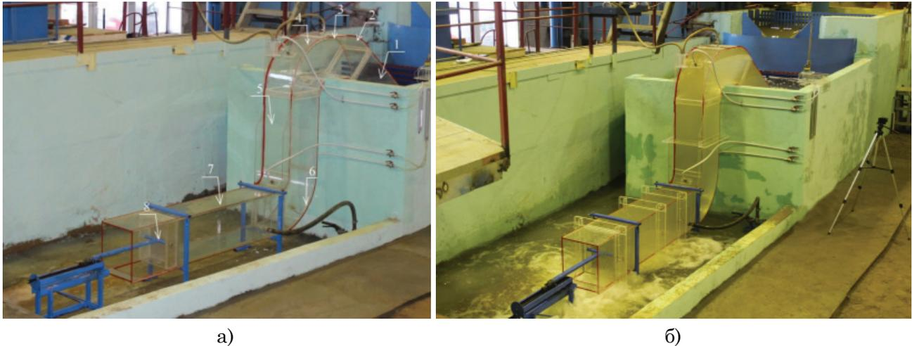
Рис. 3. Гидравлическая модель подводящего участка МГЭС с сифонным подводом и имитацией работы турбины
