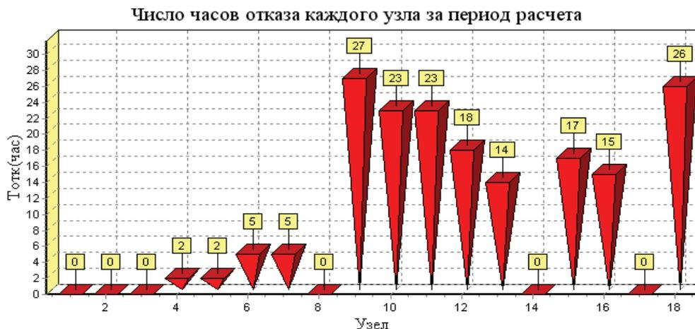
Рис. 3. Число часов отказов узлов за 20 лет эксплуатации (расчет в часы аварии).
