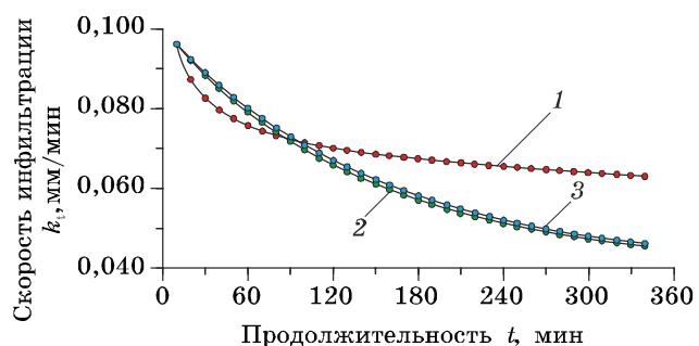
Рис. 1. Кривые инфильтрации дождевой воды в почву при дефиците влажности 15 мм:
