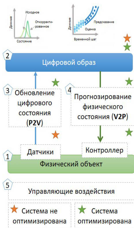
Рис. 4. Алгоритм управления щитовым затвором в режиме реального времени с применением пятимерной модели цифровой копии
