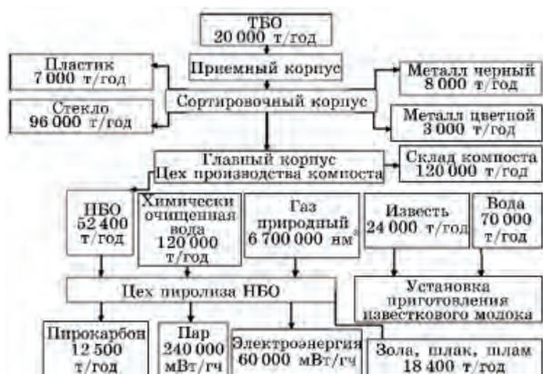
Рис. 2. Балансовая схема переработки ТБО
