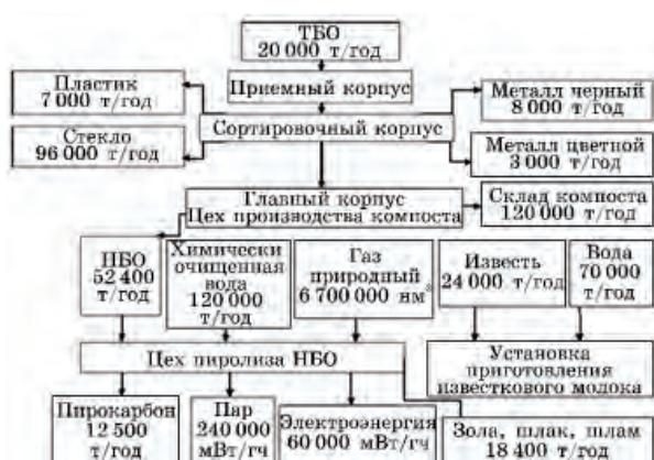
Рис. 2. Балансовая схема переработки ТБО
