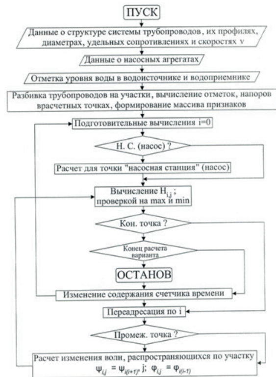
Рис. 3. Блок-схема алгоритма расчета переходных процессов
