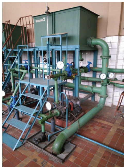
Рис. 2. Стенд для проведения параметрических испытаний центробежного насоса
