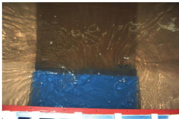
Рис. 2. Воронкообразование в акватории проектного варианта водоприемника и входного оголовка ВВ (натурный расход  $944 \text{ м}^3/\text{с}$ )
