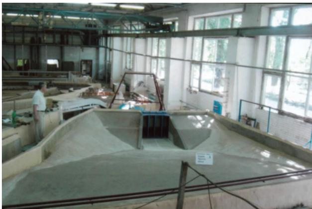
Рис. 4. Фотография модели водоприемника ГАЭС-2 после усовершенствования
