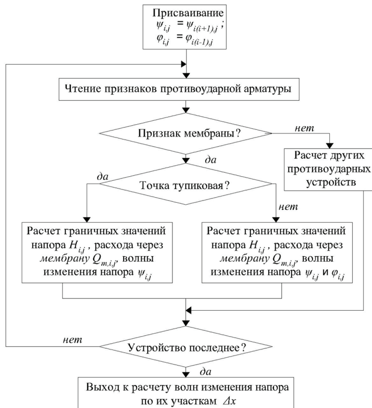
Рис. 3. Блок-схема расчета переходных процессов при использовании на трубопроводах разрывных мембран
