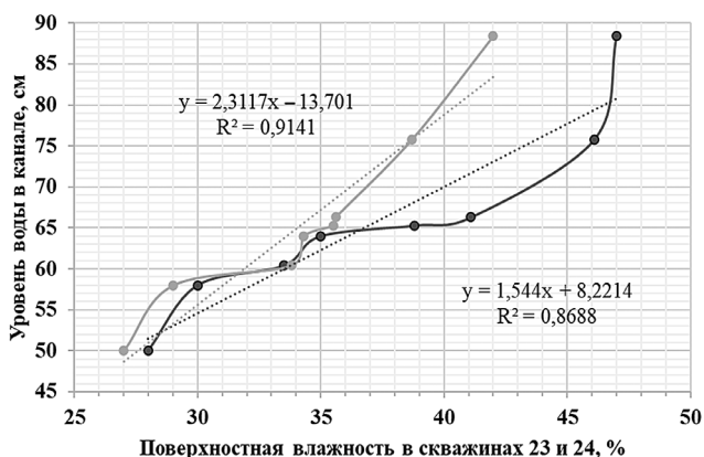
Рис. 4. График зависимости уровня воды в канале и поверхностной влажности Fig.4. Graph of dependence of water level in the channel and surface
