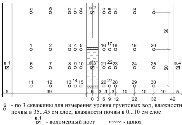
Рис. 2. План-схема расположения скважин на экспериментальном участке [5]
