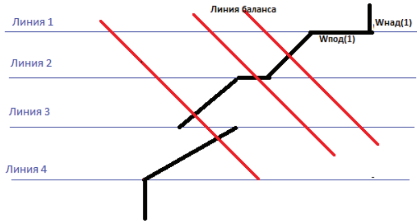
Рис. 3. Технологический график определения отдачи водохранилища по диспетчерскому графику (один расчетный интервал)
