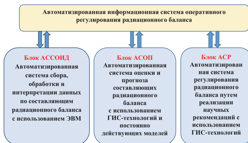
Рис. 2. Структурная схема автоматизированной информационно-функциональной системы регулирования радиационного баланса агроэкосистем
