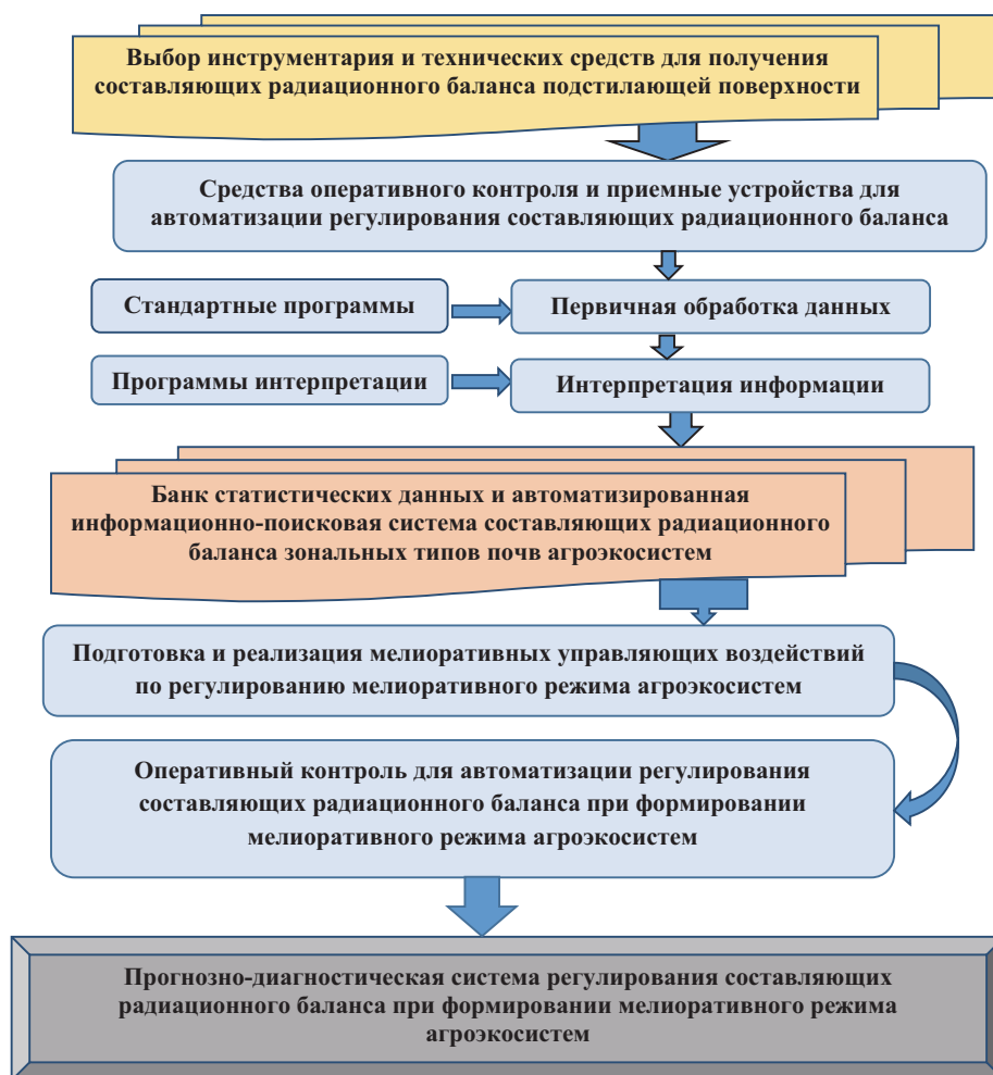
Рис. 3. Структурная схема автоматизированной прогнозно-диагностической системы регулирования радиационного баланса агроэкосистем
