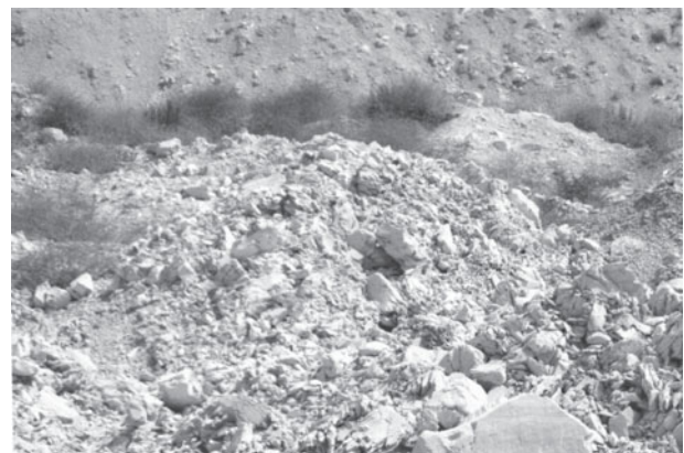
Рис. 3. Самопроизвольное разрушение материала деловых выемок (материала «6»)
