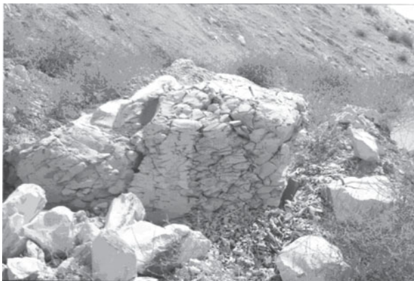
Рис. 3. Самопроизвольное разрушение материала деловых выемок (материала «6»)
