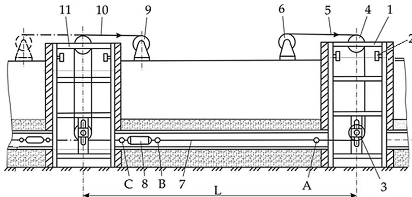
**Рис. Технологическая схема очистки закрытого горизонтального дренажа:**
