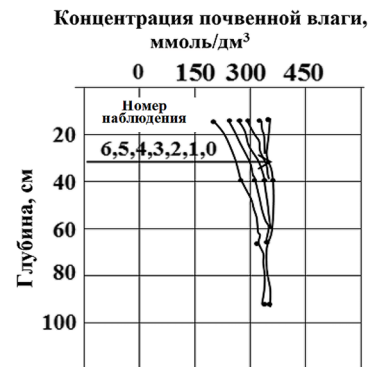
Рис. 2. Изменение концентрации почвенной влаги, ммоль/дм 3 , по слоям монолита, см, в процессе промывки
