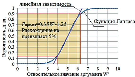
Рис. 4. Соответствие части S-образной кривой линейной зависимости
