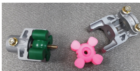
Рис. 3. Установка прототипа упругого элемента в конструкцию муфты
