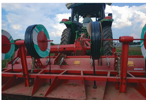
Рис. 3. Укладка капельной ленты на опытном участке Полевой опытной станции РГАУ-МСХА имени К.А. Тимирязева
