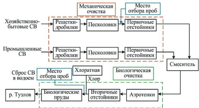
Рис. 2. Схема очистки сточных вод на КОС «Кадамовские»
