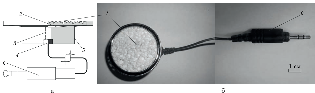
Рис. 1. Схема устройства (а) и пористая пластина (б): 1 – пористая пластина; 2 – акустическая диафрагма; 3 – соединительная трубка; 4 – узел регистрации звука (микрофон); 5 – корпус прибора; 6 – разъем подключения «мини-джек» с кабелем
