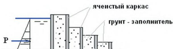
Рис. 1. Схема плотины ячеистой конструкции:  $P$  – нагрузка от гидростатического давления
